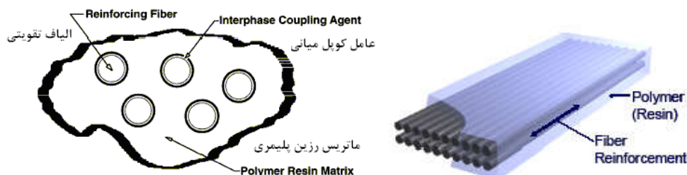
شکل 2- اجزای تشکیل دهنده FRP [3]
