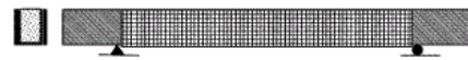
دو لایه ورقه یکپارچه CFRP روی هم و یا جهت اصلی فیبر 0 و 90 درجه
