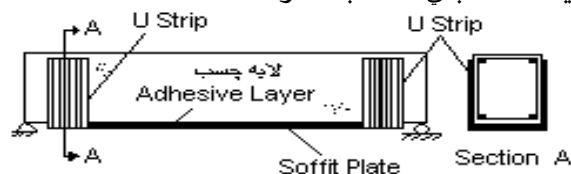
شکل-2 تیر بتن آرمه تقویت شده با ورقه FRP با نوار مهار انتهایی U شکل [1]
