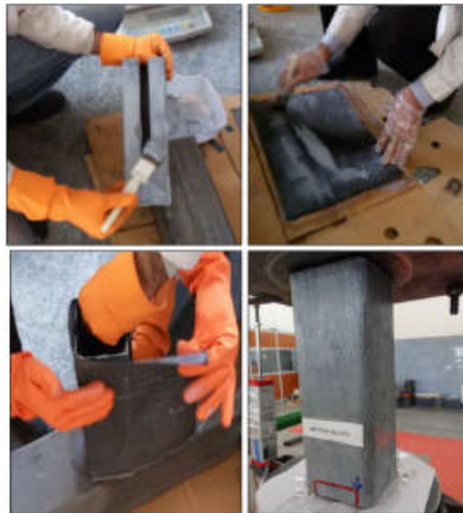
شکل (6) : مراحل چسباندن FRP به نمونه ستون فولادی
